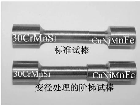
图 1 CuNiMnFe/30CrMnSi 复合材料的抗拉试棒照片
