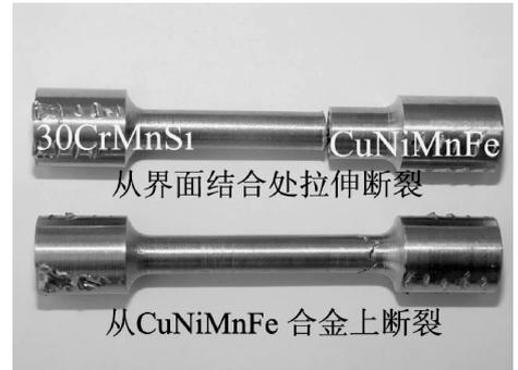
图 2 CuNiMnFe/30CrMnSi 复合材料的抗拉试棒断裂后的宏观照片
