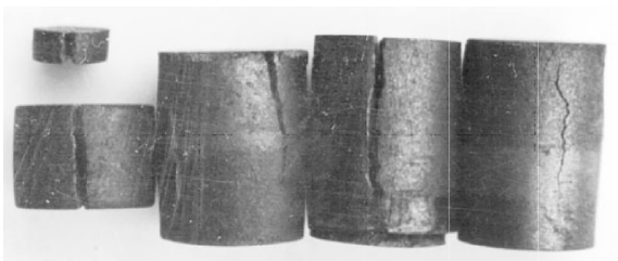
图7 铸铁单压纵向开裂
