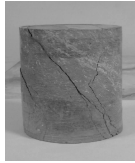
图8 砂岩单压剪断
