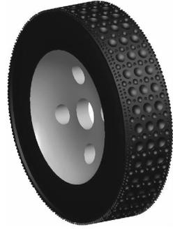
图4 仿章鱼吸盘型轮胎三维结构示意图
