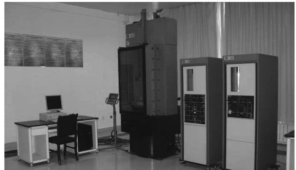
图 1 MTS815.03 伺服试验系统 Fig.1 The MTS815.03 servo test system
