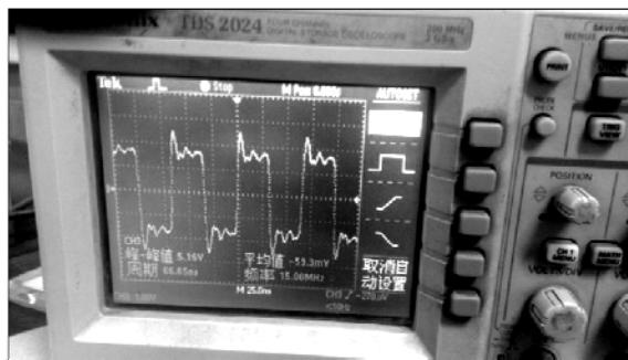
图 12 CLKOUT 脚输出时钟波形图
