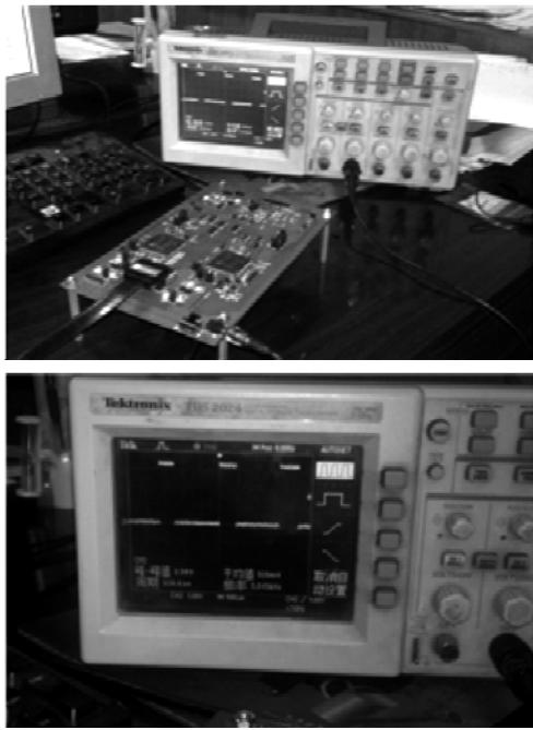
图 16 DSP1 冗余切换后 PWM 输出波形图
