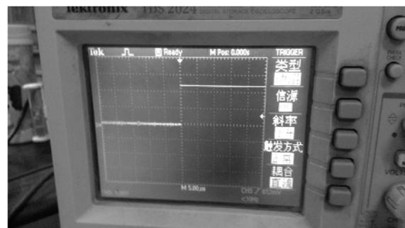
图 13 发生故障后 74LS123 的  $\bar{Q}_1$  脚跳变图
