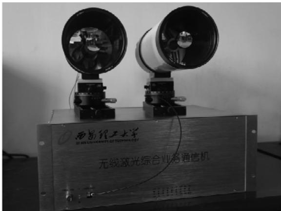
图 9 无线激光综合业务通信机样机
