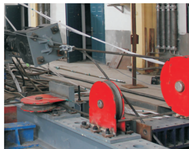
图 9 钢丝末端与 MTS 连接
