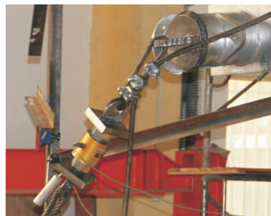
图 10 力传感器及位移计布置
