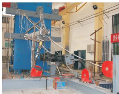
图 6 B 1 相复合材料横担试验安装现场
