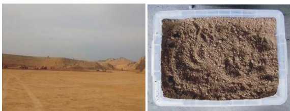
(a) 现场取土样 (b) 黄土
