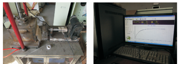
(a) 水平剪切、拉拔装置
