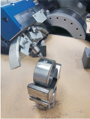
图 9 X 射线应力衍射仪
