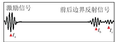
图7 前后边界反射回波示意图
