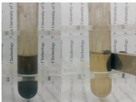
(b) Fe<sub>3</sub>O<sub>4</sub>@h-C的分散体系与磁性吸附图
