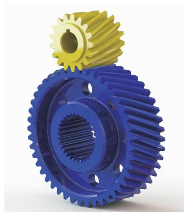
图 2 某斜齿轮三维模型
