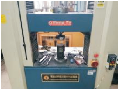
图 3 电脑式伺服控制材料试验机 Fig. 3 Computer servo control material testing machine
