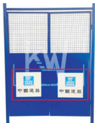
图6 中建公司施工升降机安全门
