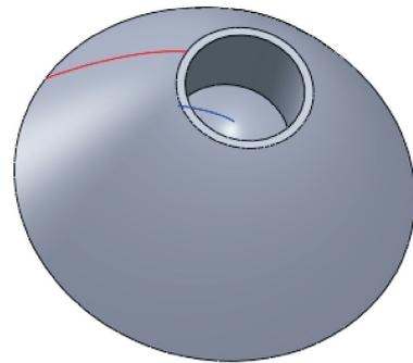
图 7 TIR 透镜三维实体图示
