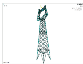
图4 输电铁塔有限元模型
