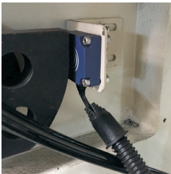
图 5 印刷机收卷摆辊角度传感器 Fig. 5 Angle sensor for winding roller of printing press
