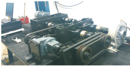
图 6 单环路系统试验台
