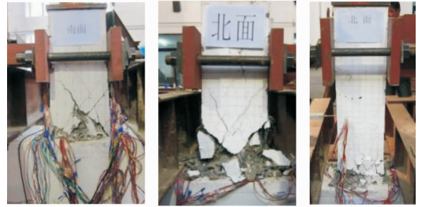
(a) 剪切斜压破坏 (b) 弯剪破坏 (c) 弯曲破坏
