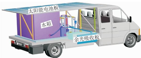
图 5 激光绿篱机系统的车载示意图
