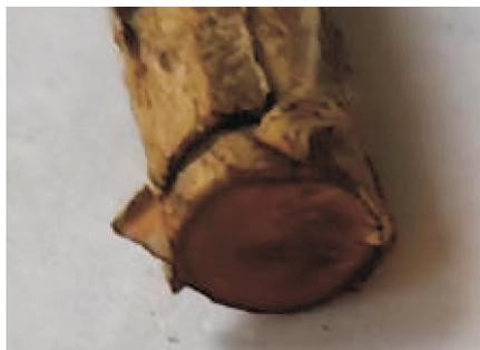
图 2 用  $10.6 \mu\text{m}$  波长激光切割小叶黄杨木质茎的碳化效果
