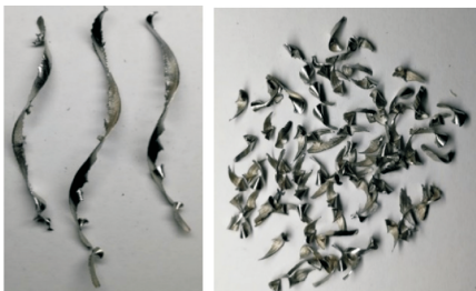
(a) 小进给量时的切屑 (b) 大进给量时的切屑
