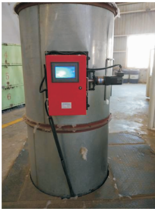
图 7 籽棉含杂率在线检测装置
