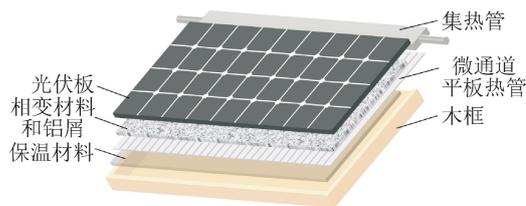
图2 光伏光热墙体结构图
