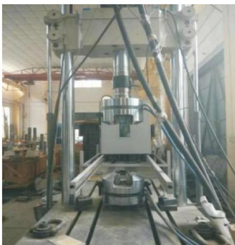
图 3 试验加载装置
