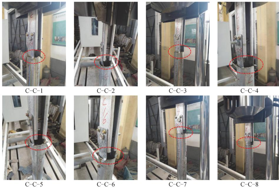
图 5 冷弯薄壁高强度合金钢光伏支架柱脚的抗压破坏现象
