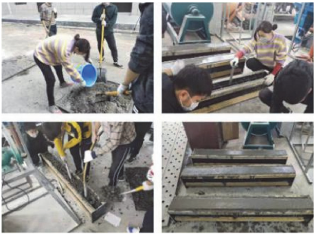
图 1 试件制作过程图
