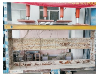
图 13 二维物理相似模型试验系统 Fig. 13 Two-dimensional physical similarity model test system
