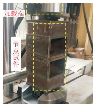
图 2 加载装置 Fig. 2 Loading device
