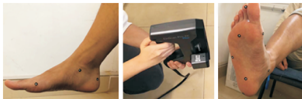
图 11 三维扫描采集足部点云数据
