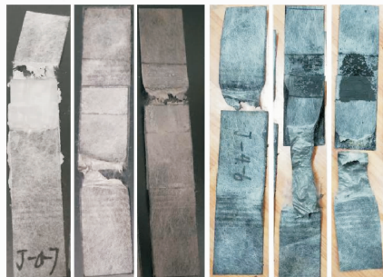
(b) 各龄期搭接试件断裂形貌示意图
