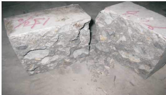
图 1 抗压试验试件劈裂面
